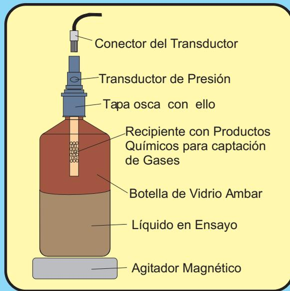
7. Completar a 500 ml con agua destilada y transferir a la botella respirométrica.
